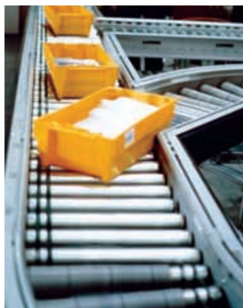
Detalhe de sistema de movimentação interna de cargas (caixetas). Foto do autor Acervo - Museu Nacional dos Correios.
