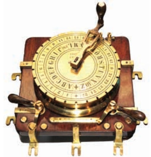
Aparelho Breguet - criado por Louis-François-Clément Bréguet por volta de 1845, usado nas experiências de 1851. Foto: Jair Xavier Acervo - Museu Nacional dos Correios
